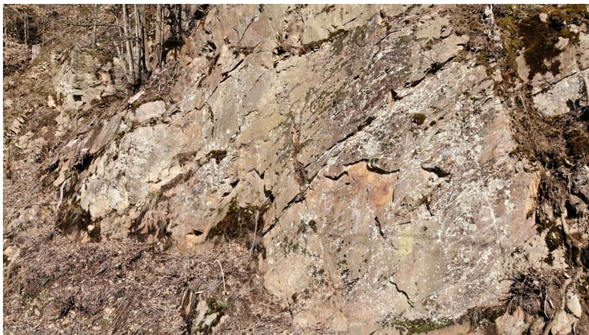
Obrázek 26: detail stavu masivu v km 11,260 - 11,270 se strmým úklonem ploch odlučnosti
